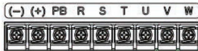
Hình 3-7: 3PH Terminal mạch chính (30-37kW)
