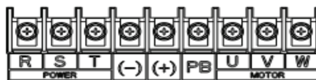
Hình 3-7: 3PH Terminal mạch chính (30-37kW)
