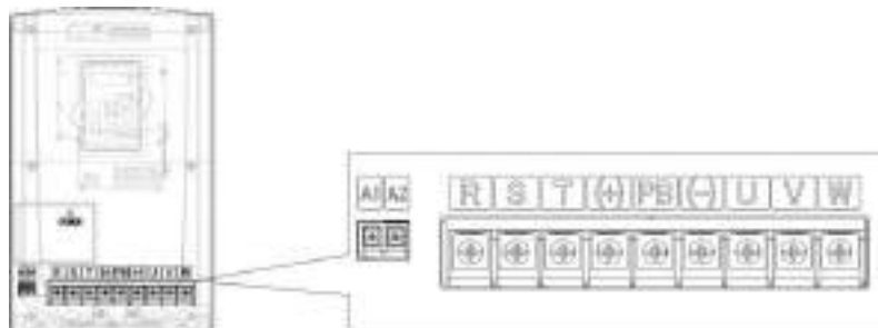
Hình 4-13 Terminals mạch động lực của biến tần 380 V 22 – 30 kW
